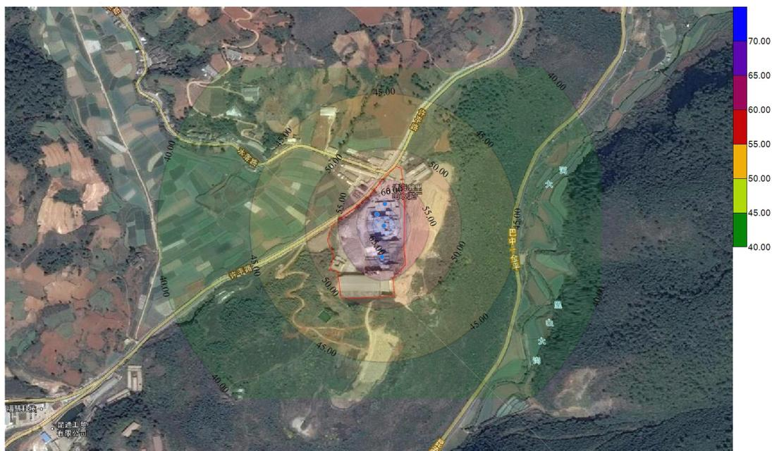
图 7-1 项目生产区噪声等值线图
